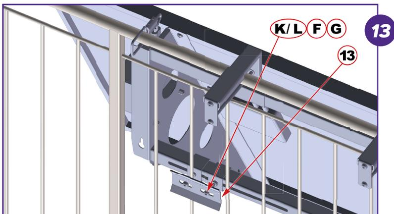
Posizionare le parti (13) nella posizione più idonea e poi serrare tramite le viti (K/L) e le relative rosette (F) fornite nel kit fissaggio con i dadi saldati sulla parte 14.
