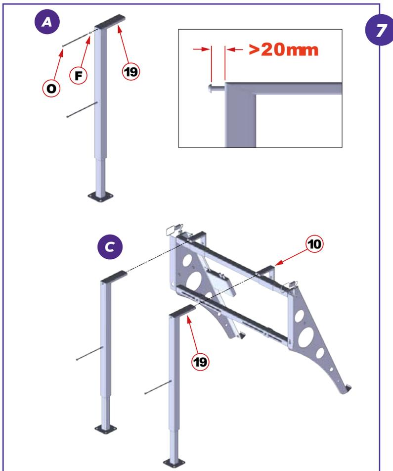
Step A - avvitare la vite (O) con relativa rosetta (F) all'elemento (19) lasciando un minimo di 20 mm di filettatura;
