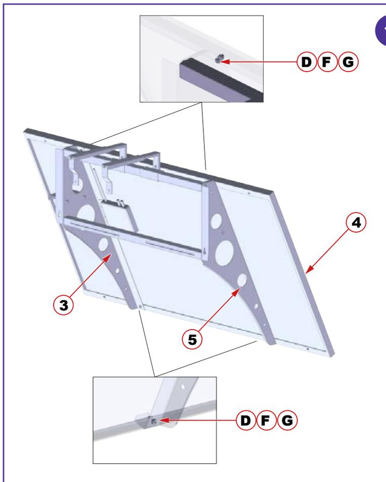
Fissare il modulo fotovoltaico (4) alla struttura.
