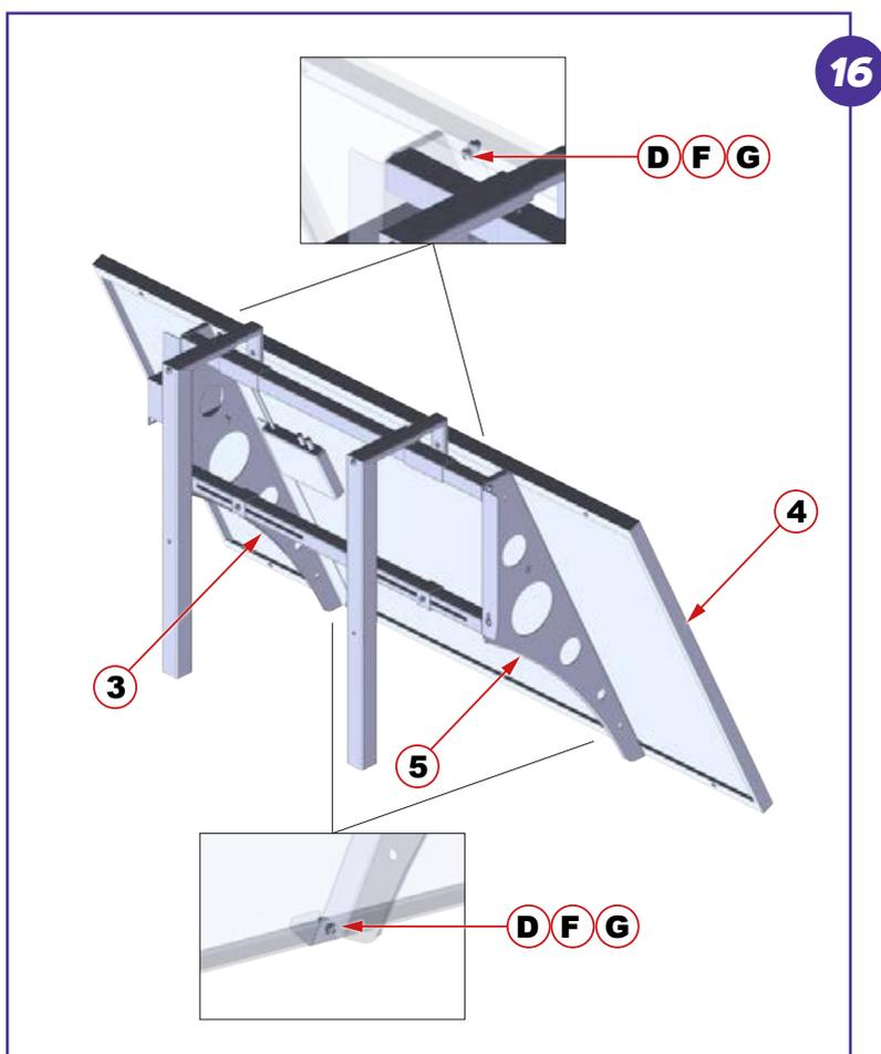
Fissare il modulo fotovoltaico (4) alla struttura, dove quest'ultima è ancora poggiata sul pavimento del balcone.
