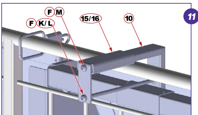
Serrare le parti (15/16), a seconda della configurazione selezionata, con le (10), utilizzando le viti (M) con le relative rosette (F) fornite nel kit fissaggio.
