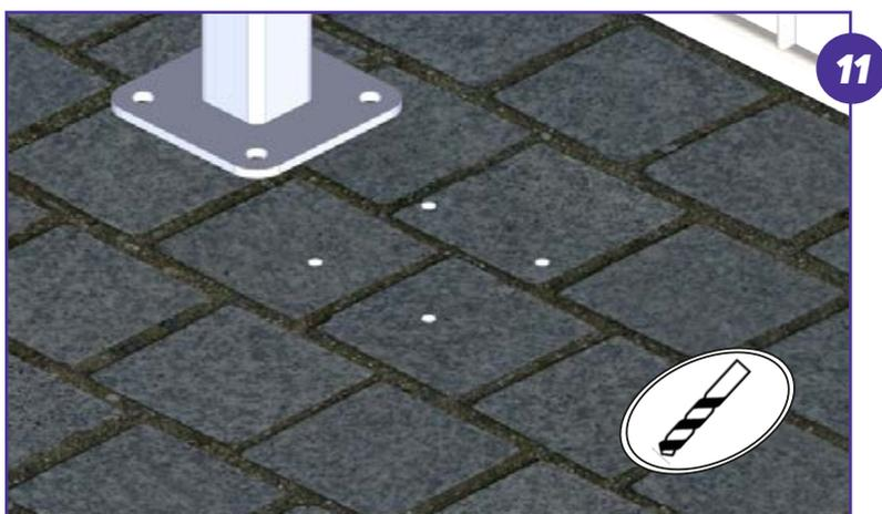
Spostare la struttura dalla posizione nominale e forare il pavimento ad una profondità di 90 millimetri con punta da trapano Ø10, ponendo attenzione a rispettare gli interessi segnati.
