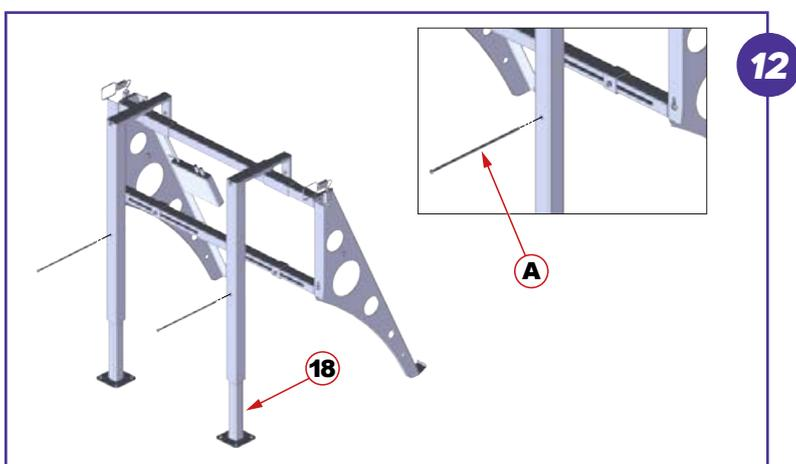
Rimuovere le viti (A) indicate in figura e separare le gambe dalla struttura, rimuovendo i cordini di sicurezza (9).
