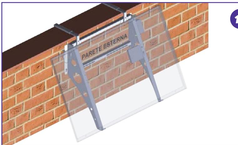
Posizionare il sistema completo di pannello fotovoltaico al muro del balcone in muratura, assicurando i cordini di sicurezza (9) alla struttura come indicato al punto 3 e assicurandosi che i punti di ancoraggio interni ed esterni alla parete siano inseriti correttamente negli opportuni fori della struttura.
