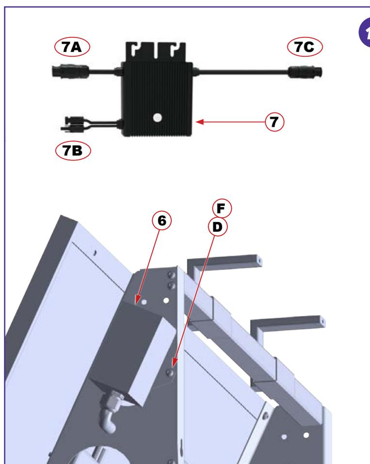
Connettere i cavetti del modulo fotovoltaico ai cavi maschio e femmina del microinverter (7B).
