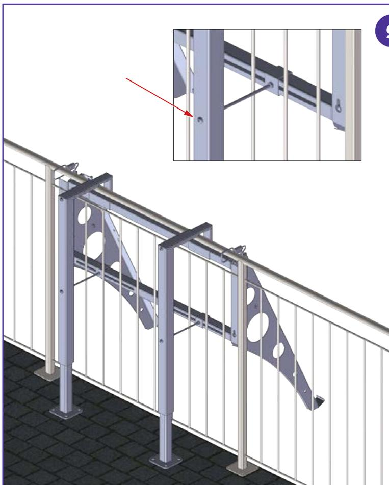
Posizionare la struttura sulla ringhiera e assicurarsi che il telaio sia centrato e le gambe in asse.
