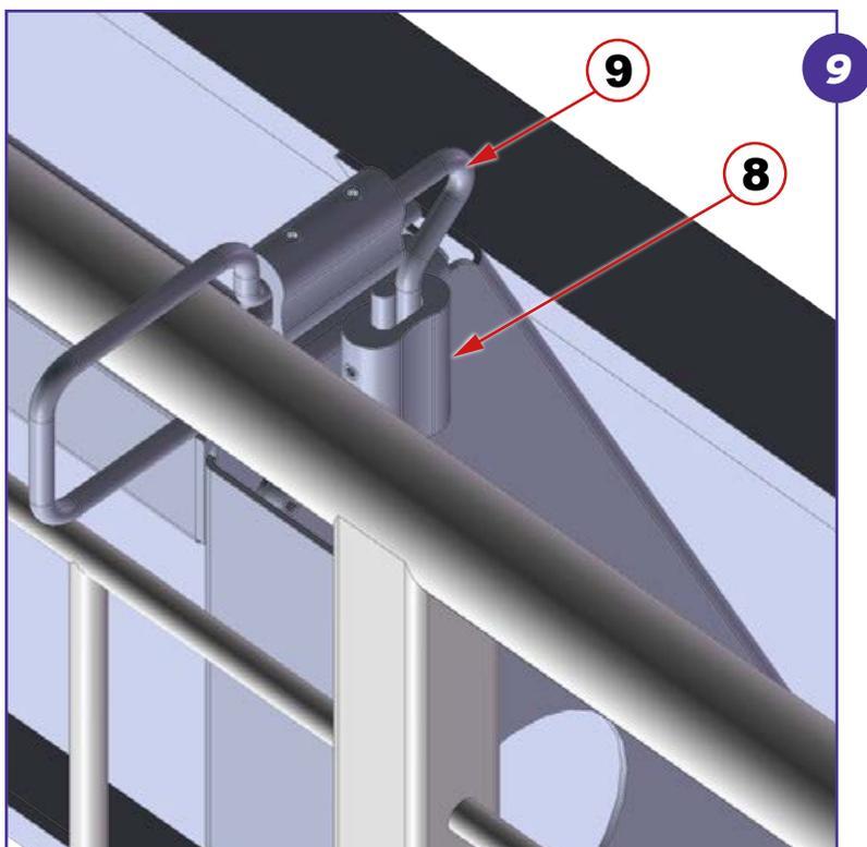
Completare il montaggio dei cordini di sicurezza (9) assicurando entrambi al mancorrente della ringhiera seguendo le istruzioni riportate in figura 4.
