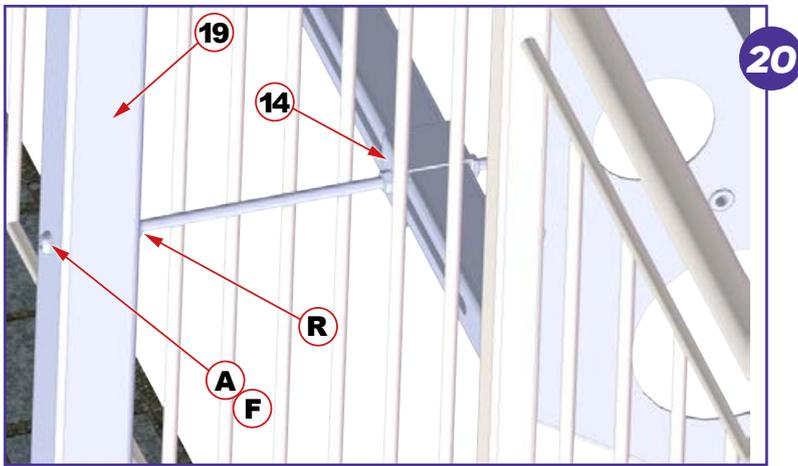
Inserire le viti (A) attraverso l'elemento (18), posizionando un dado (R) fra l'elemento (18) e la ringhiera. Spingere con una mano l'elemento (18) affinché la struttura non aderisca alla ringhiera.
