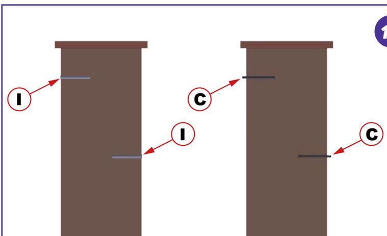
Utilizzare la pompetta (W) e lo spazzolino (Y) in dotazione per pulire i quattro buchi sulla parete interna ed esterna. Nel caso di parete con mattone forato, inserire prima all'interno del foro le calze in dotazione (I). Applicare l'ancorante chimico (T) nei quattro fori servendosi della pistola (X). Procedere con la sostituzione del beccuccio in caso di indurimento dell'ancorante.
