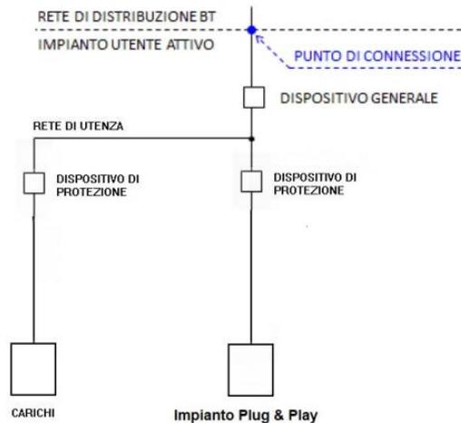
Schema elettrico di massima per la connessione alla rete di un Impianto di produzione Plug&Play.
