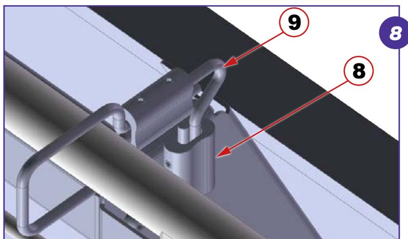
Completare il montaggio dei cordini di sicurezza (9) assicurandoli entrambi al mancorrente della ringhiera seguendo le istruzioni riportate nello step 4.
