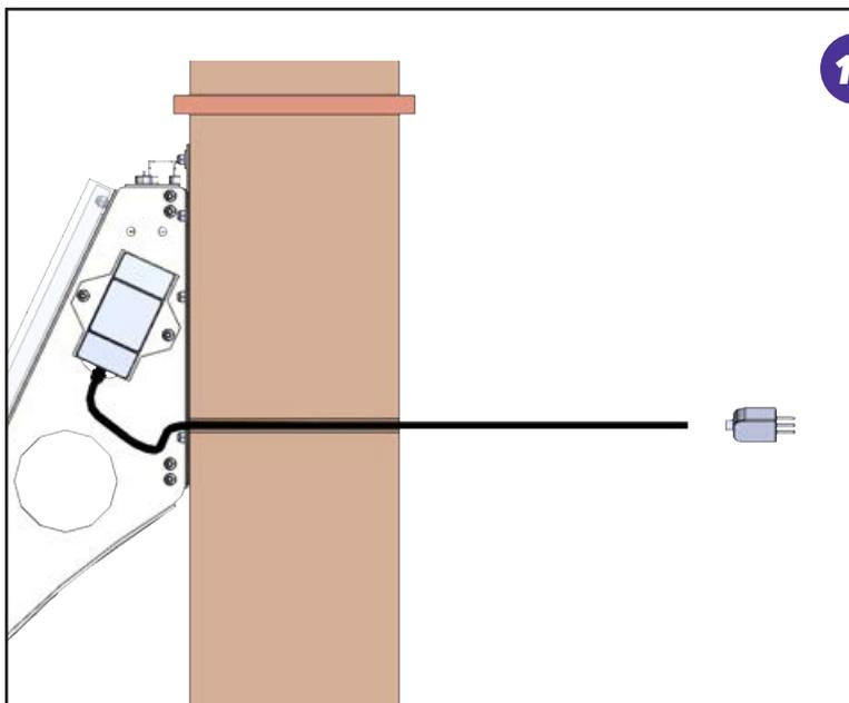
Passare il cavo nel foro praticato nel muro e rimontare la spina. sigillare il foro utilizzando il prodotto a base di schiuma (AC) per sigillare il foro realizzato.
