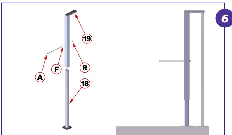
Assemblare l'elemento (18) con l'elemento (19). Prendere riferimento sulla ringhiera e inserire l'elemento (A) in maniera parziale fissandolo con un dado (R) come in figura. L'elemento (19) dovrà arrivare a battuta (o prossimo) del mancorrente della ringhiera.
