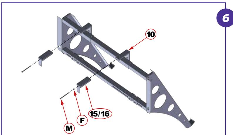
Assemblare gli elementi (15/16), a seconda della configurazione selezionata, con gli elementi (10) tramite le n°2 viti (M) con le relative rosette (F).
