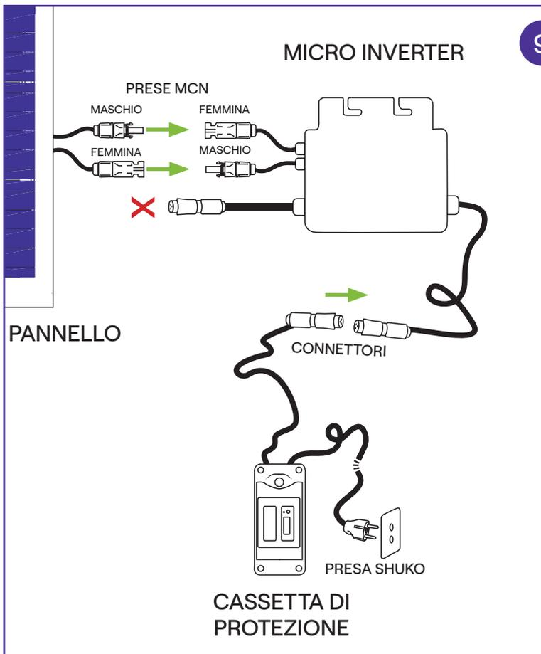
Connettere i cavi del modulo fotovoltaico ai cavi maschio e femmina del microinverter (7).
