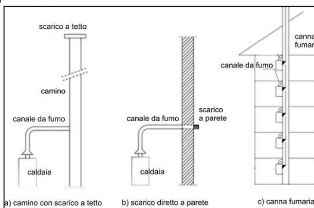
**Scarico a parete** (prevede di scaricare i fumi subito al di sopra della caldaia, ove possibile, oppure in prossimità di essa, attraverso una parete; vedi immagine b): puoi passare alla domanda successiva
